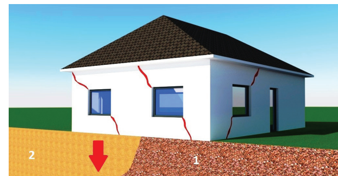
Obr. 4. Charakteristické trhliny ve zdivu, které jsou způsobeny sesednutím stavebního objektu, kde jsou základy založeny na jedné straně neúnosné zeminy (1. únosná zemina, 2. neúnosná zemina).
